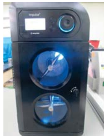
ランダムタンブル形 ピリング試験機 (ASTM D3512 対応)
