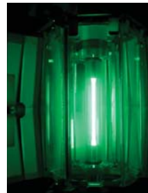
耐光試験機 (キセノン) (ISO 105-B02 対応)
