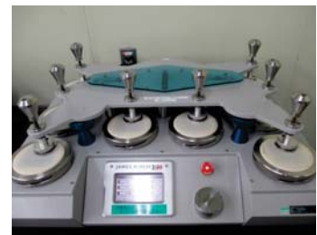
マーチンデル形摩耗試験機 (ISO 12947 対応)
