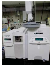
ガスクロマトグラフ 質量分析計 (EN14682 対応)
